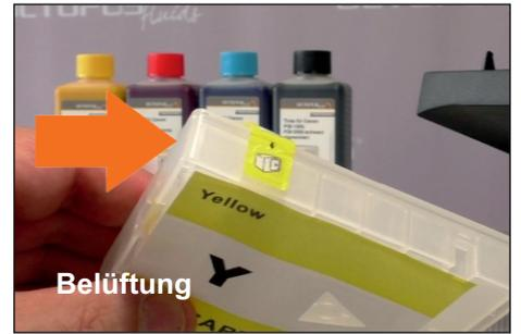
Die durchsichtigen Körper der Leerpatronen alternativ für PGI-1500 oder PGI-2500 verfügen an der Rückseite über eine Einfüllöffnung für die Nachfülltinte. Diese Öffnung ist mit einem weichen Silikonstopfen verschlossen. Auf der Oberseite der Fill In Tintenpatronen ist die Belüftungsöffnung angebracht. Im Auslieferungszustand ist diese Öffnung je nach Produktcharge mit gelbem Klebeband oder einem Silikonstopfen verschlossen.
