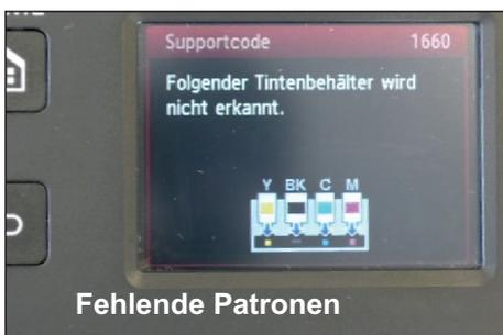
Am Druckerdisplay wird angezeigt, dass keine Patronen eingesetzt sind (wir hatten zuvor alle PGI-2500 Patronen entfernt). Mit diesem Status fährt der Druckkopfschlitten beim Öffnen der Frontklappe eigenständig in die Wechselposition und alle fehlenden Patronen können jetzt mit Unterstützung durch den Maxify Drucker eingesetzt werden.
