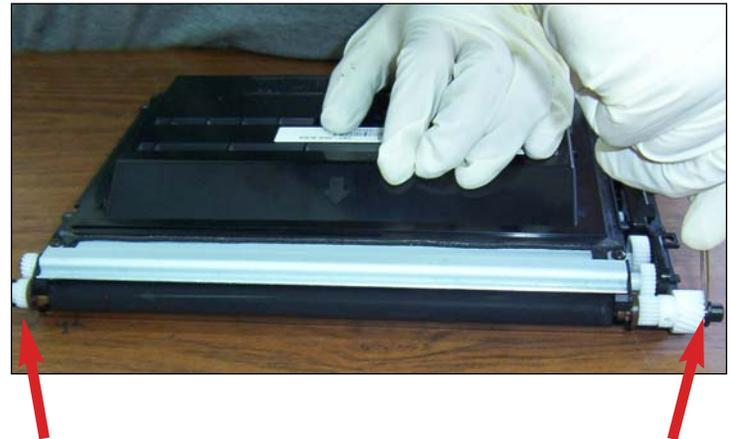
**REMOVING THE DEVELOPER ROLLER**
