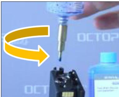
Entfernen Sie den QU-Fill™ mit einer leichten Drehung aus dem Tintenauslass. Durch die Drehung verhindern Sie, dass der Dichtgummi des Federventils herausgezogen wird. Sollte die Dichtung doch einmal herausrutschen, drücken Sie diese behutsam wieder in ihre Position zurück.
