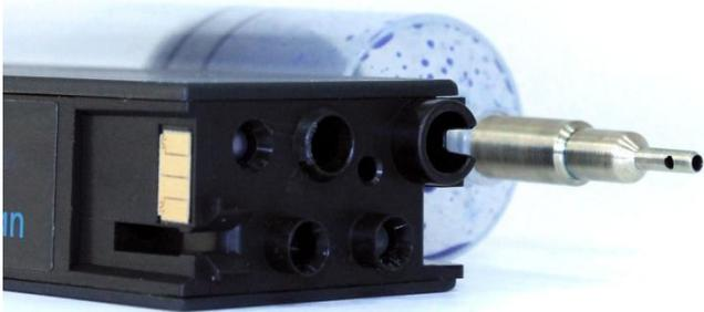
Der QU-FILL™ *profi* ermöglicht Ihnen das Nachfüllen der HP 950, 951, HP 932, 933 und HP 970, 971 Tintenpatronen ohne die Patronen öffnen zu müssen. Nach ein paar vorbereitenden Schritten öffnen Sie mit dem QU-FILL™ *profi* das Federvertil des Tintenauslasses, erzeugen im Patronen-inneren einen Unterdruck und die Nachfüll-tinte wird von allein in die Patrone gesaugt.
