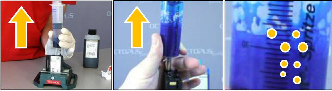
Ziehen Sie den Kolben der Luer Lock Spritze langsam nach oben und halten Sie ihn für ein bis zwei Sekunden in der oberen Position. Auf diese Weise entsteht in der Patrone ein Unterdruck. Es ist zu erkennen, dass Luftblasen durch die Tinte in der Spritze nach oben steigen.
