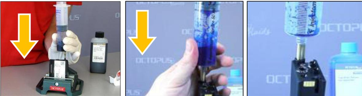
Lassen Sie anschließend den Kolben der Spritze los. Dieser gleitet eigenständig in den Spritzenkörper zurück, es besteht keine Notwendigkeit zu drücken. Die Nachfülltinte strömt in das Patroneninnere ein und gleicht dort den Unterdruck aus. Wiederholen Sie diesen Vorgang bis beim Unterdruck herstellen (Kolben nach oben ziehen) keine Luftblasen mehr aufsteigen und die gewünschte Menge Nachfülltinte in die Patrone eingesogen wurde.
